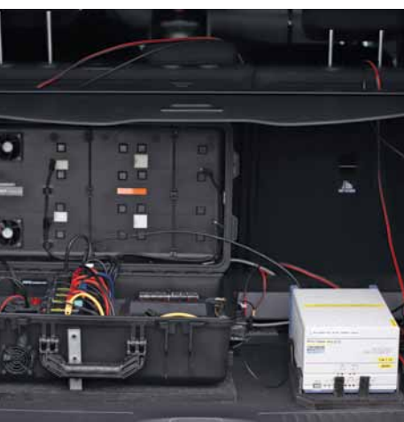
Die von P3 speziell entwickelte Steuer-elektronik kontrolliert die Smartphones während der Drivetests und sammelt alle von ihnen protokollierten Daten.
