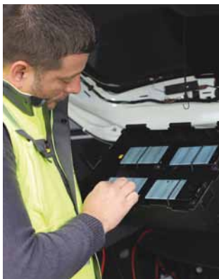
Jedes Drivetest-Fahrzeug transportierte sechs Smartphones vom Typ Samsung Galaxy S8.
