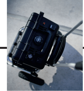
Die Walktest-Teams setzen Trolleys oder Rucksäcke ein, in denen starke Akkus die Test-Smartphones speisen.
