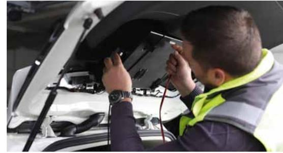
Se montaron dos cajas en las lunas trasera y laterales de cada uno de los vehículos de medición para dar cabida a ocho teléfonos inteligentes por vehículo.
