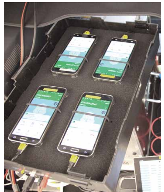
Cada vehículo portaba cuatro teléfonos para las pruebas de datos y ocho teléfonos para las pruebas de voz. Fueron alojados en tres cajas especiales con cuatro smartphones cada una.
