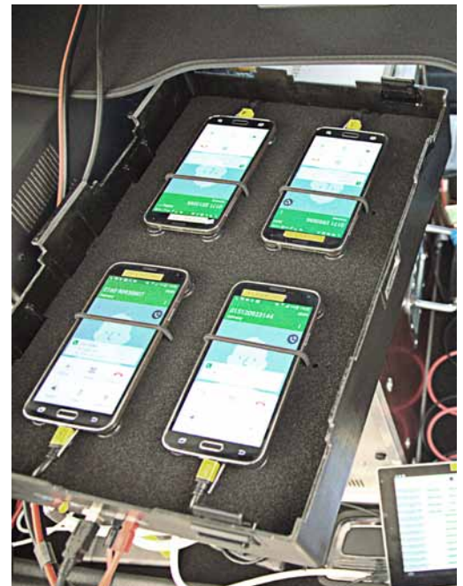
Cada caja contenía cuatro smartphones, lo cual permitió realizar pruebas simultáneas a las cuatro operadoras.
