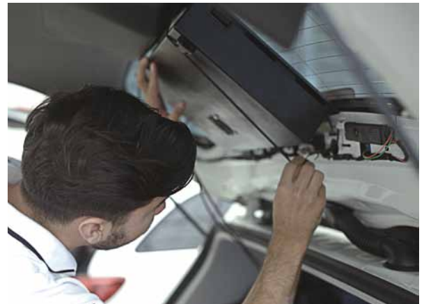
Se montaron tres cajas en las lunas trasera y laterales de cada uno de los vehículos de medición para dar cabida a 12 teléfonos por vehículo.
