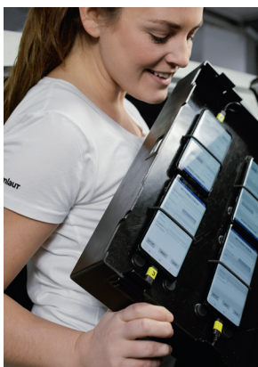
Cada vehículo de drive test llevaba ocho teléfonos inteligentes para realizar las pruebas de voz y datos.
