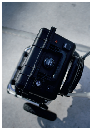
Los equipos de walk test utilizaron carros en los que los teléfonos inteligentes eran alimentados por potentes baterías recargables.
