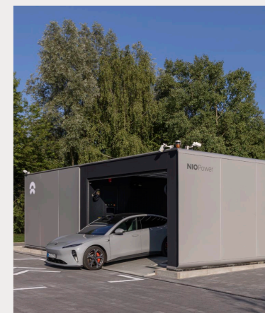
Innovativ: In den „Power Swap Stations“ bekommt ein ET7 binnen fünf Minuten einen voll geladenen Akku eingepflanzt.
