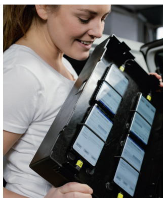
Jedes Drivetest-Fahrzeug transportierte sechs Smartphones für die Sprach- und Datentests.
